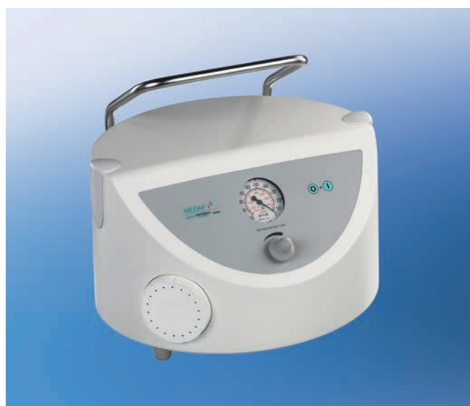
BORA UP 2080 module de base : le module de base comprend un vacuomètre, un dispositif de réglage du vide, un filtre anti-bactérien, deux capuchons de protection des griffes mécaniques et une poignée, complet avec deux clips pour fixation au rail porte-appareillage 25 x 10 mm (DIN).
